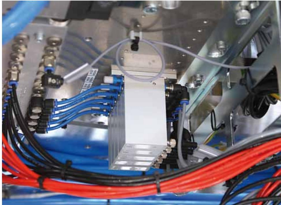
**Piezodruckregelventile VEAB** steuern die Zylinder im Schweißwerkzeug. Vorteil: permanente Prozessdatenüberwachung und volle Flexibilität bei der Einstellung des Schweißdrucks.
