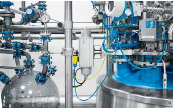
**Standard:** Festo Schwenkantriebe DAPS steuern Kugelhähne und Absperrklappen am Reaktor.
