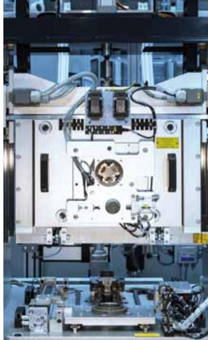
**In Station 1** sorgen Pneumatik und Elektrik von Festo für die Montage des Verdichtergehäuses auf der Rumpfgruppe.
