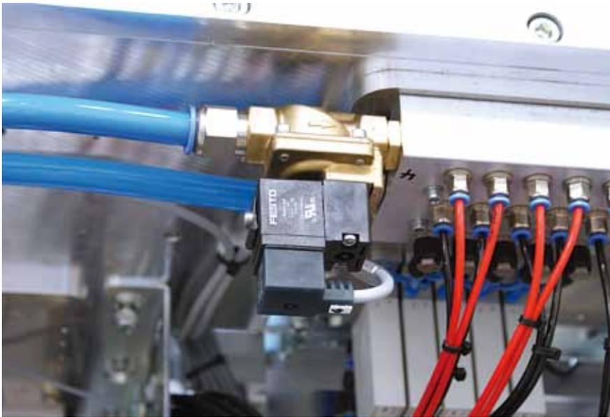
**Prozessventile vom Typ MN1H** sorgen für die Kühlluft auf den Schweißeinheiten.
