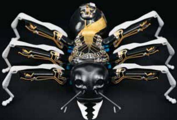
**Einmalige Kombination:** 3D-MID-Technologie auf lasergesinterten Formteilen.
