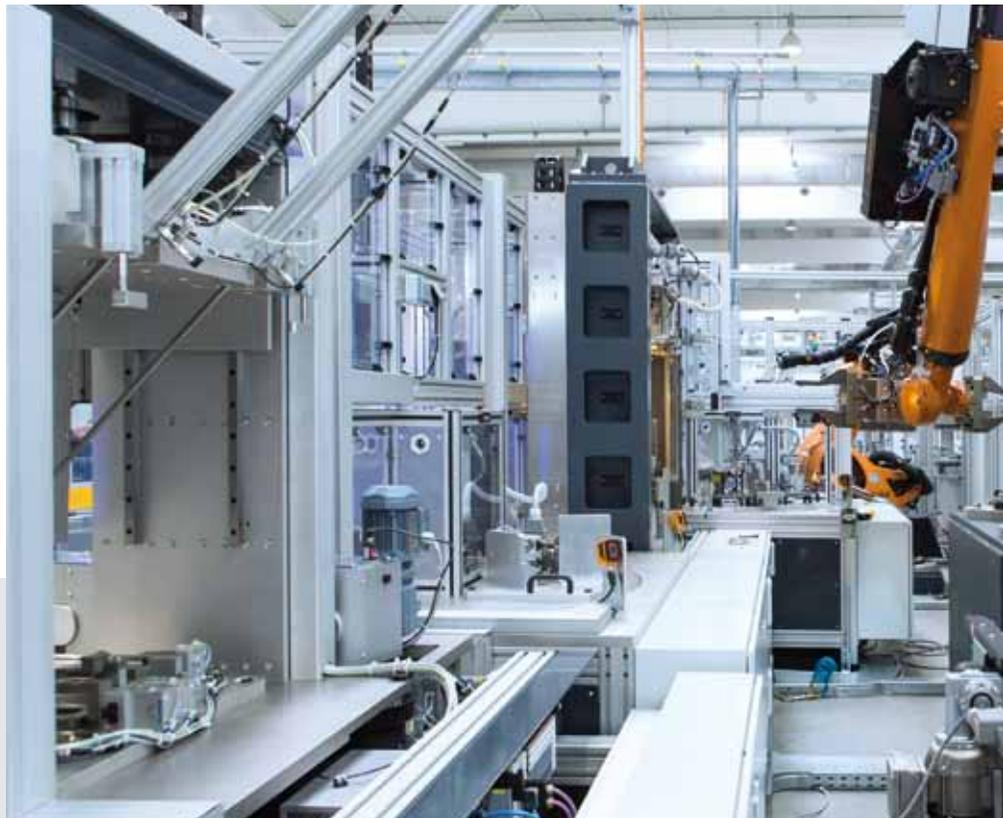
**Blick hinter die Kulissen:** Der Roboter platziert die Turbolader an der Rückseite in den einzelnen Fertigungszellen, die flexibel ausgetauscht werden können.
