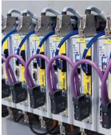
**Controller vom Typ CMMP** mit integriertem Sicherheitsmodul steuern die Handlings in den Bereichen Wärmeleitpastenauftrag und Warmvernietung.
