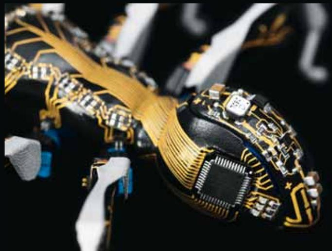
**Hochintegrierte Bauteile:** konstruktive und elektrische Funktionen in einem.
