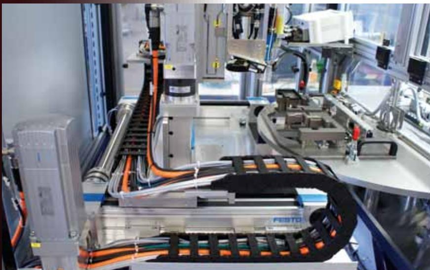
**Ein einbaufertig geliefertes Handling** sorgt für den gleichmäßigen Auftrag einer 2-Komponenten-Wärmeleitpaste.
