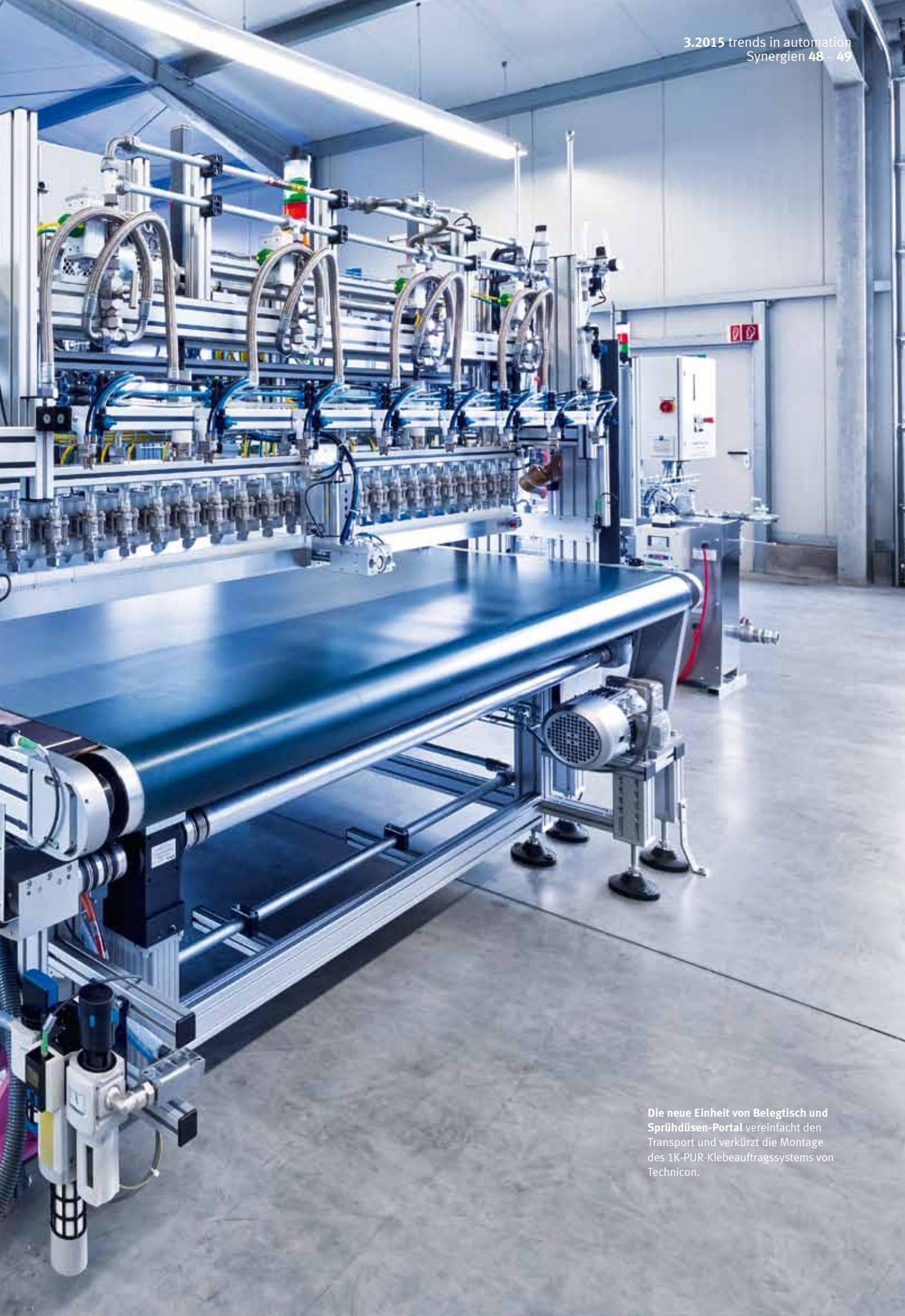
Die neue Einheit von Belegtisch und Sprühdüsen-Portal vereinfacht den Transport und verkürzt die Montage des 1K-PUR-Klebeauftragungssystems von Technicon.
