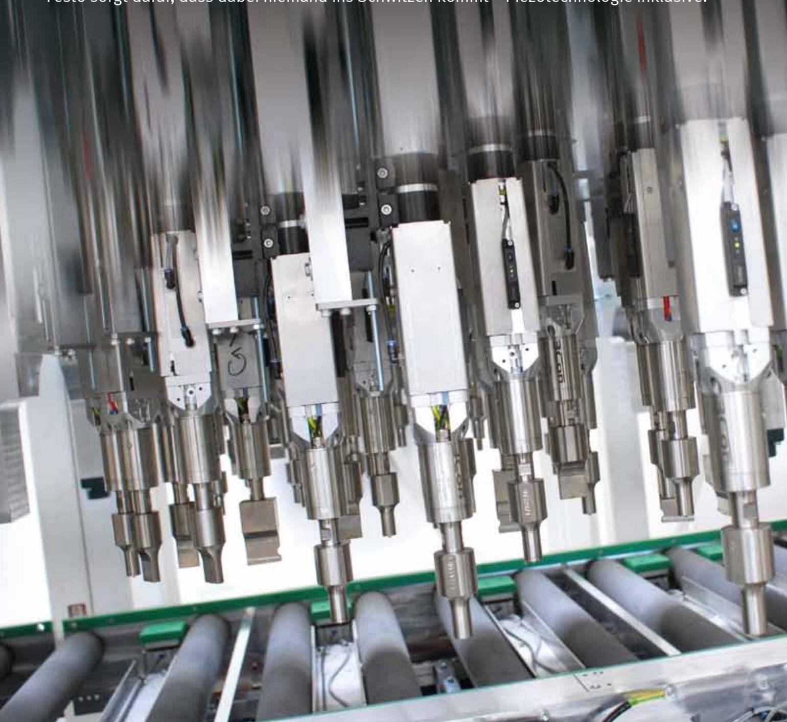
ADNGF-Führungszylinder mit SDAT-Positionstransmittern sorgen für die exakte Zustellung der Ultraschallschweißsonotroden.
